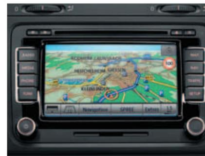
**Радионавигационная система RNS-510** имеет богатый набор функций: сенсорный дисплей высокого разрешения, жесткий диск 30 Гб, DVD-привод, устройство считывания SD-карт и разъем AUX-IN для подключения внешних источников аудио-сигнала.
