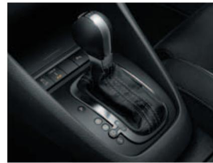
**Коробка передач DSG** с двойным сцеплением переключает скорости в сотые доли секунды без задержек и разрыва потока мощности, что дает по-настоящему спортивное ускорение. Шестиступенчатая схема благодаря ее высокой эффективности положительно влияет на экономичность.
