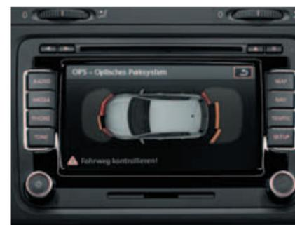
**Система ParkPilot** с помощью датчиков парковки акустическим или визуальным сигналом предупредит Вас о препятствии перед автомобилем или позади него. Чем ближе препятствие – тем выше частота сигналов.
