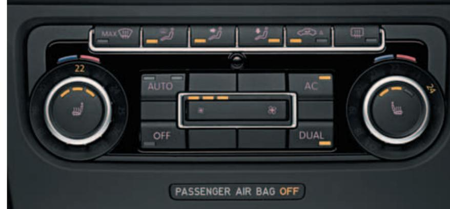
**Климатическая установка Climatronic** предлагает отдельную регулировку температуры в зоне водителя и переднего пассажира. Таким образом, каждый может без проблем установить желаемый режим. На дисплее отображается выбранная температура с точностью до одного градуса, а датчик качества воздуха при необходимости в автоматическом режиме переведет систему в режим рециркуляции.
