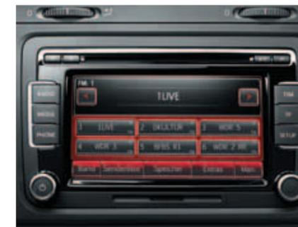
Управление **магнитолой RCD-510** осуществляется при помощи большого цветного сенсорного дисплея. Магнитола воспроизводит файлы MP3 и WMA, оснащена встроенным CD-чейнджером на 6 дисков и 8 динамиками, ее выходная мощность составляет 4 x 20 Вт.
